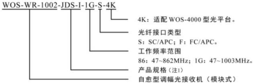
**注 1:** 本机型为两路光信号输入，单路射频信号输出
